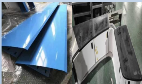
高铁裙板、电器柜
